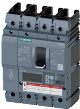
Interruttore automatico 3VA6 UL Frame 150 Classe del potere di interruzione H 65kA @ 480V a 4 poli, protezione impianto ETU550, LSI,  $In=40A$  protezione da sovraccarico  $Ir=16A\dots40A$  protezione da cortocircuito  $Isd=0,6\dots10x\ In$ ,  $li=1,5\dots12x\ In$  protezione del conduttore di neutro impostabile (OFF, fino al 160%) senza collegamento
