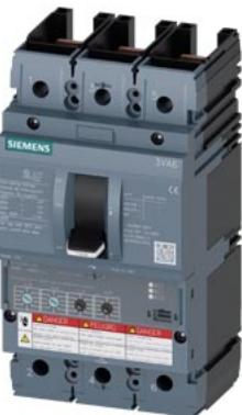
interruttore automatico 3VA6 UL frame 150 classe del potere di interruzione L 150 kA con 480 V a 3 poli, protezione impianto ETU330, LIG, In=150 A protezione da sovraccarico, 100 % nominale Ir=60 A ... 150 A protezione da cortocircuito Ii=1,5 ... 10 x In protezione da guasto verso terra Ig=0,2 ... 1 x In, tg=0,1/0,3s senza collegamento
