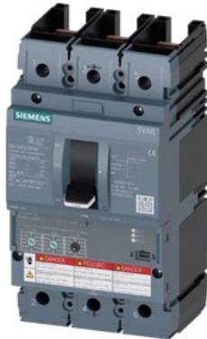
interruttore automatico 3VA6 UL frame 150 classe del potere di interruzione L 150 kA con 480 V a 3 poli, protezione impianto ETU320, LI, In=150 A protezione da sovraccarico, 100 % nominale Ir=60 A ... 150 A protezione da cortocircuito Ii=1,5 ... 10 x In senza collegamento
