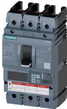
Interruttore automatico 3VA6 UL Frame 150 Classe del potere di interruzione C 100kA @ 480 V a 3 poli, protezione impianto ETU556, LSI, In=150A protezione da sovraccarico Ir=60A...150A protezione da cortocircuito I<sub>sd</sub>=0,6..10x I<sub>n</sub>, I<sub>i</sub>=1,5..10x I<sub>n</sub> protezione del conduttore di neutro opzionale con trasformatore di corrente, fino a 160% allarme di guasto verso terra Segnalazione tramite EFB300 o COM senza collegamento
