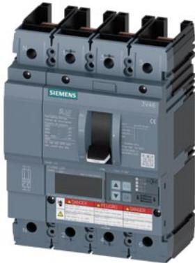
interruttore automatico 3VA6 UL frame 150 classe del potere di interruzione C 100 kA con 480V a 4 poli, protezione impianto ETU560, LSIG, In=150 A protezione da sovraccarico, 100 % nominale Ir=60 A ... 150 A protezione da cortocircuito Isd=0,6 ... 10x In, Ii=1,5 ... 10x In protezione del conduttore di neutro regolabile (OFF, fino a 100 %) protezione da guasto verso terra Ig=0,2 ... 1 x In= tg=0,05 ... 0,8 s senza collegamento
