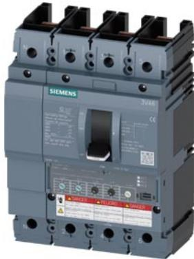
interruttore automatico 3VA6 UL frame 150 classe del potere di interruzione C 100 kA con 480V a 4 poli, protezione impianto ETU330, LIG, In=150 A protezione da sovraccarico, 100 % nominale Ir=60 A ... 150 A protezione da cortocircuito li=1,5 ... 10 x In protezione del conduttore di neutro regolabile (OFF, 100 %) protezione da guasto verso terra lg=0,2...1 x In= tg=0,1/0,3s senza collegamento
