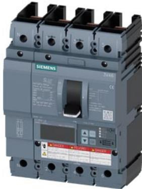
interruttore automatico 3VA6 UL frame 150 classe del potere di interruzione H 65 kA con 480V a 4 poli, protezione impianto ETU850, LSI, In=150 A protezione da sovraccarico, 100 % nominale Ir=60 A ... 150 A protezione da cortocircuito I<sub>sd</sub>=0,6 ... 10x I<sub>n</sub>, I<sub>i</sub>=1,5 ... 10x I<sub>n</sub> protezione del conduttore di neutro regolabile (OFF, fino a 100 %) senza collegamento
