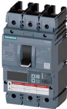
interruttore automatico 3VA6 UL frame 150 classe del potere di interruzione H 65 kA con 480V a 3 poli, protezione impianto ETU820, LI, In=150 A protezione da sovraccarico, 100 % nominale Ir=60 A ... 150 A protezione da cortocircuito Ii=1,5 ... 10 x In senza collegamento
