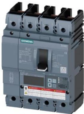
Interruttore automatico 3VA6 UL Frame 150 Classe del potere di interruzione H 65kA @ 480V a 4 poli, protezione impianto ETU560, LSIG,  $I_n=150A$  protezione da sovraccarico  $I_r=60A\dots150A$  protezione da cortocircuito  $I_{sd}=0,6\dots10x I_n$ ,  $I_l=1,5\dots10x I_n$  protezione del conduttore di neutro impostabile (OFF, fino a 100%) protezione da guasto verso terra  $I_g=0,2\dots1 \times I_n$   $t_g=0,05-0,8s$  senza collegamento
