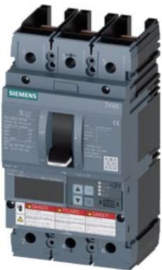
interruttore automatico 3VA6 UL frame 150 classe del potere di interruzione H 65 kA con 480V a 3 poli, protezione impianto ETU550, LSI, In=150 A protezione da sovraccarico, 100 % nominale Ir=60 A ... 150 A protezione da cortocircuito Isd=0,6 ... 10x In, li=1,5 ... 10x In protezione del conduttore di neutro opzionale con trasformatore di corrente esterno, fino a 160 % senza collegamento
