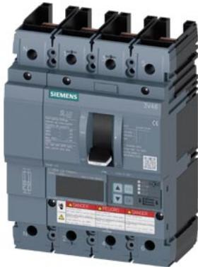
interruttore automatico 3VA6 UL frame 150 classe del potere di interruzione M 35 kA con 480V a 4 poli, protezione impianto ETU856, LSI, In=150 A protezione da sovraccarico, 100 % nominale Ir=60 A ... 150 A protezione da cortocircuito Isd=0,6 ... 10x In, Ii=1,5 ... 10x In protezione del conduttore di neutro regolabile (OFF, fino a 100 %) allarme di guasto verso terra segnalazione tramite EFB300 o COM senza collegamento
