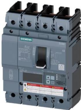
Interruttore automatico 3VA6 UL Frame 150 Classe del potere di interruzione M 35kA @ 480V a 4 poli, protezione impianto ETU860, LSIG, In=150A protezione da sovraccarico Ir=60A...150A protezione da cortocircuito Isd=0,6..10x In, Ii=1,5..10x In protezione del conduttore di neutro impostabile (OFF, fino a 100%) protezione da guasto verso terra Ig=0,2...1 x In= tg=0,05-0,8s senza collegamento
