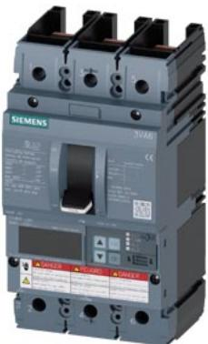
interruttore automatico 3VA6 UL frame 150 classe del potere di interruzione M 35 kA con 480V a 3 poli, protezione impianto ETU860, LSIG, In=150 A protezione da sovraccarico, 100 % nominale Ir=60 A ... 150 A protezione da cortocircuito Isd=0,6 ... 10x In, Ii=1,5 ... 10x In protezione del conduttore di neutro opzionale con trasformatore di corrente esterno, fino a 160 % protezione da guasto verso terra Ig=0,2 ... 1 x In, tg=0,05...0,8s senza collegamento
