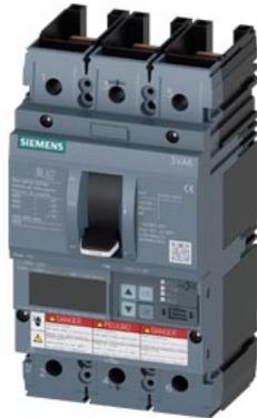
Interruttore automatico 3VA6 UL Frame 150 Classe del potere di interruzione M 35kA @ 480V a 3 poli, protezione impianto ETU860, LSIG,  $I_n=150A$  protezione da sovraccarico  $I_r=60A...150A$  protezione da cortocircuito  $I_{sd}=0,6..10x I_n$ ,  $I_i=1,5..10x I_n$  protezione del conduttore di neutro opzionale con trasformatore di corrente, fino a 160% protezione da guasto verso terra  $I_g=0,2...1 x I_n$ ,  $t_g=0,05-0,8s$  senza collegamento
