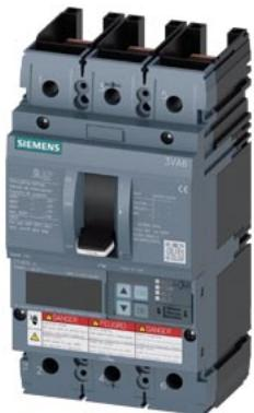
interruttore automatico 3VA6 UL frame 150 classe del potere di interruzione M 35 kA con 480V a 3 poli, protezione impianto ETU820, LI, In=150 A protezione da sovraccarico, 100 % nominale Ir=60 A ... 150 A protezione da cortocircuito Ii=1,5 ... 10 x In senza collegamento
