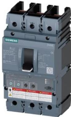
Interruttore automatico 3VA6 UL Frame 150 Classe del potere di interruzione M 35kA @ 480V a 3 poli, protezione impianto ETU350, LSI, In=150A protezione da sovraccarico Ir=60A...150A protezione da cortocircuito Isd=1,5...10 x Ir, li=10 x In senza collegamento
