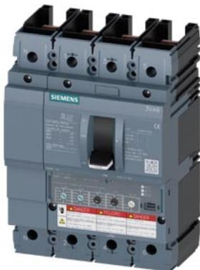
Interruttore automatico 3VA6 UL Frame 150 Classe del potere di interruzione M 35kA @ 480V a 4 poli, protezione impianto ETU330, LIG,  $In=150A$  protezione da sovraccarico  $Ir=60A\dots150A$  protezione da cortocircuito  $li=1,5\dots10 \times In$  protezione del conduttore di neutro impostabile (OFF, 100%) protezione da guasto verso terra  $lg=0,2\dots1 \times In= tg=0,1/0,3s$  senza collegamento
