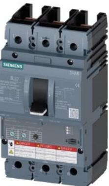
Interruttore automatico 3VA6 UL Frame 150 Classe del potere di interruzione M 35kA @ 480V a 3 poli, protezione impianto ETU320, LI, In=150A protezione da sovraccarico Ir=60A...150A protezione da cortocircuito Ii=1,5...10 x In senza collegamento
