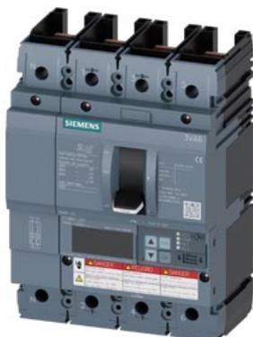
interruttore automatico 3VA6 UL Frame 150 classe del potere di interruzione E 200 kA @ 480 V a 4 poli, protezione impianto ETU860, LSIG, In=150 A protezione da sovraccarico Ir=60A ... 150A protezione da cortocircuito I<sub>sd</sub>=0,6 ... 10 x I<sub>n</sub>, I<sub>i</sub>=1,5 ... 12 x I<sub>n</sub> protezione del conduttore di neutro impostabile (OFF, fino a 100 %) protezione da guasto verso terra I<sub>g</sub>=0,2 ... 1 x I<sub>n</sub>, t<sub>g</sub>=0,05 ... 0,8 s senza collegamento
