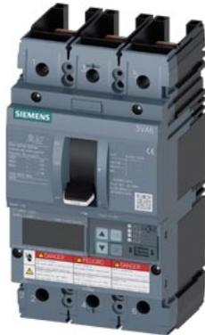
interruttore automatico 3VA6 UL Frame 150 classe del potere di interruzione E 200 kA @ 480 V a 3 poli, protezione impianto ETU860, LSIG,  $I_n=150$  A protezione da sovraccarico  $I_r=60A \dots 150A$  protezione da cortocircuito  $I_{sd}=0,6 \dots 10 \times I_n$ ,  $I_i=1,5 \dots 12 \times I_n$  protezione del conduttore di neutro opzionale con CT est. fino a 160 % protezione da guasto verso terra  $I_g=0,2 \dots 1 \times I_n$ ,  $t_g=0,05 \dots 0,8$  s senza collegamento
