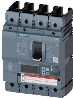
interruttore automatico 3VA6 UL frame 150 classe del potere di interruzione L 150 kA con 480 V a 4 poli, protezione impianto ETU560, LSIG,  $I_n=100$  A protezione da sovraccarico, 100 % nominale  $I_r=40$  A ... 100 A protezione da cortocircuito  $I_{sd}=0,6$  ...  $10 \times I_n$ ,  $i_i=1,5..12 \times I_n$  protezione del conduttore di neutro regolabile (OFF, fino a 150 %) protezione da guasto verso terra  $I_g=0,2$  ...  $1 \times I_n$   $t_g=0,05$  ... 0,8 s senza collegamento
