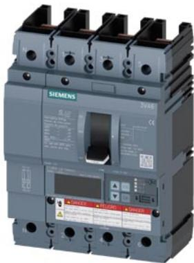
interruttore automatico 3VA6 UL frame 150 classe del potere di interruzione C 100 kA con 480V a 4 poli, protezione impianto ETU856, LSI, In=100 A protezione da sovraccarico, 100 % nominale Ir=40 A ... 100 A protezione da cortocircuito Isd=0,6 ... 10x In, li=1,5..12x In protezione del conduttore di neutro regolabile (OFF, fino a 150 %) allarme di guasto verso terra segnalazione tramite EFB300 o COM senza collegamento
