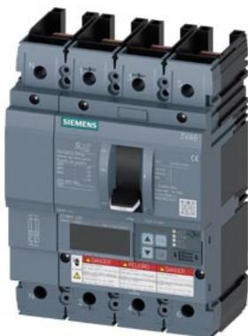
interruttore automatico 3VA6 UL frame 150 classe del potere di interruzione C 100 kA @ 480 V a 4 poli, protezione impianto ETU860, LSIG,  $In=100$  A protezione da sovraccarico  $Ir=40$  A ... 100 A protezione da cortocircuito  $Isd=0,6..10x In$ ,  $li=1,5..12x In$  protezione del conduttore di neutro regolabile (OFF, fino a 150 %) protezione da guasto verso terra  $lg=0,2$  ... 1 x  $In=tg=0,05$  ... 0,8 s senza collegamento
