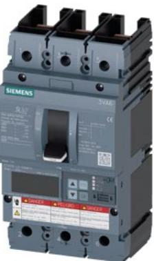
Interruttore automatico 3VA6 UL Frame 150 Classe del potere di interruzione C 100kA @ 480 V a 3 poli, protezione impianto ETU556, LSI, In=100A protezione da sovraccarico Ir=40A...100A protezione da cortocircuito Isd=0,6..10x In, Ii=1,5..12x In protezione del conduttore di neutro opzionale con trasformatore di corrente, fino a 160% allarme di guasto verso terra Segnalazione tramite EFB300 o COM senza collegamento
