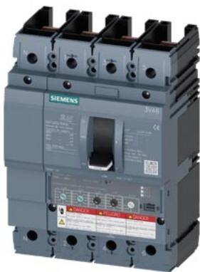
Interruttore automatico 3VA6 UL Frame 150 Classe del potere di interruzione C 100kA @ 480 V a 4 poli, protezione impianto ETU330, LIG, In=100A protezione da sovraccarico Ir=40A...100A protezione da cortocircuito Ii=1,5...12 x In protezione del conduttore di neutro impostabile (OFF, 50%, 100%) protezione da guasto verso terra Ig=0,2...1 x In= tg=0,1/0,3s senza collegamento
