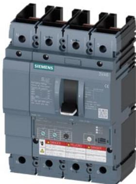
interruttore automatico 3VA6 UL frame 150 classe del potere di interruzione C 100 kA con 480V a 4 poli, protezione impianto ETU320, LI, In=100 A protezione da sovraccarico, 100 % nominale Ir=40 A ... 100 A protezione da cortocircuito li=1,5 ... 12 x In protezione del conduttore di neutro regolabile (OFF, 50 %, 100 %) senza collegamento
