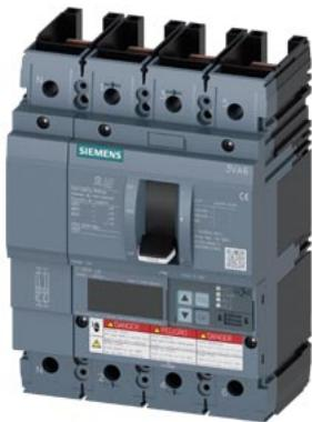
interruttore automatico 3VA6 UL frame 150 classe del potere di interruzione H 65 kA @ 480 V a 4 poli, protezione impianto ETU850, LSI, In=100 A protezione da sovraccarico Ir=40 A ... 100 A protezione da cortocircuito Isd=0,6..10x In, Ii=1,5..12x In protezione del conduttore di neutro regolabile (OFF, fino a 150 %) senza collegamento
