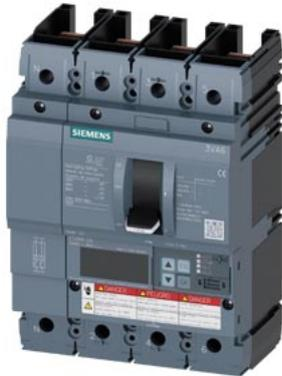
interruttore automatico 3VA6 UL frame 150 classe del potere di interruzione M 35 kA @ 480 V a 4 poli, protezione impianto ETU550, LSI, In=100 A protezione da sovraccarico Ir=40 A ... 100 A protezione da cortocircuito I<sub>sd</sub>=0,6..10x I<sub>n</sub>, I<sub>i</sub>=1,5..12x I<sub>n</sub> protezione del conduttore di neutro regolabile (OFF, fino a 150 %) senza collegamento
