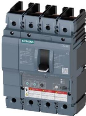
Interruttore automatico 3VA6 UL Frame 150 Classe del potere di interruzione M 35kA @ 480V a 4 poli, protezione impianto ETU320, LI, In=100A protezione da sovraccarico Ir=40A...100A protezione da cortocircuito Ii=1,5...12 x In protezione del conduttore di neutro impostabile (OFF, 50%, 100%) senza collegamento
