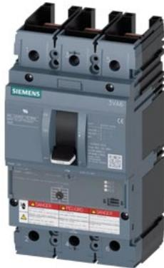
Interruttore automatico 3VA6 UL Frame 150 a 3 poli, protezione avviatore ETU310M, I, In=100A senza protezione da sovraccarico protezione da cortocircuito li=3...15 x In senza collegamento
