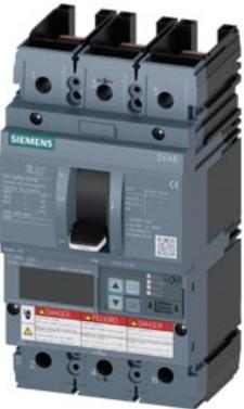
interruttore automatico 3VA6 UL Frame 150 classe del potere di interruzione E 200 kA @ 480 V a 3 poli, protezione impianto ETU860, LSIG, In=100 A protezione da sovraccarico Ir=40 A ... 100A protezione da cortocircuito Isd=0,6 ... 10 x In, li=1,5 ... 12 x In protezione del conduttore di neutro opzionale con CT est. fino a 160 % protezione da guasto verso terra Ig=0,2 ... 1 x In, tg=0,05 ... 0,8 s senza collegamento
