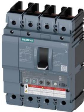
interruttore automatico 3VA6 UL Frame 150 classe del potere di interruzione E 200 kA @ 480 V a 4 poli, protezione impianto ETU350, LSI, In=100 A protezione da sovraccarico Ir=40 A ... 100A protezione da cortocircuito I<sub>sd</sub>=1,5 ... 10 x I<sub>r</sub>, I<sub>i</sub>=12 x I<sub>n</sub> protezione del conduttore di neutro impostabile (OFF, 50 %, 100 %) senza collegamento
