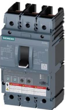
interruttore automatico 3VA6 UL Frame 150 classe del potere di interruzione E 200 kA @ 480 V a 3 poli, protezione impianto ETU350, LSI, In=100 A protezione da sovraccarico Ir=40 A ... 100A protezione da cortocircuito lsd=1,5 ... 10 x Ir, li=12 x In senza collegamento
