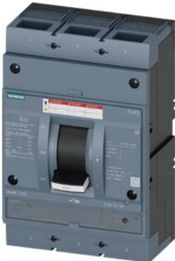
interruttore automatico 3VA5 UL Frame 800 classe del potere di interruzione M 35 kA con 480 V a 2 poli, protezione impianto TM230, FTAM, In=800 A, protezione da sovraccarico Ir=800 A con regolazione fissa protezione da cortocircuito li=5 ... 10 x In attacchi piatti a vite
