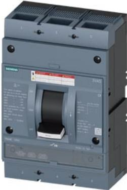
interruttore scatolato 3VA5 UL Frame 800 potere di interruzione in cortocircuito max. 100 kA con 480 V a 2 poli MCS110, In=800 A, senza protezione da sovraccarico protezione intrinseca li=12 x In attacchi piatti a vite
