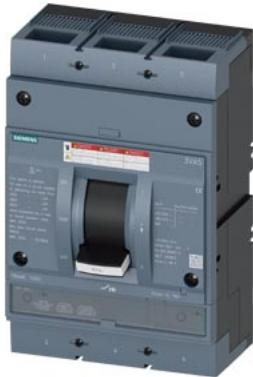
interruttore scatolato 3VA5 UL Frame 800 potere di interruzione in cortocircuito max. 65 kA con 480 V a 3 poli MCS110, In=800 A, senza protezione da sovraccarico protezione intrinseca li=12 x In attacchi piatti a vite
