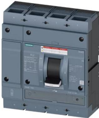
interruttore automatico 3VA5 UL Frame 800 classe del potere di interruzione C 100 kA con 480 V a 4 poli, protezione impianto TM230, FTAM, In=700 A protezione da sovraccarico Ir=700 A con regolazione fissa protezione da cortocircuito li=5 ... 10 x In conduttore di neutro 1 attacco piatto a vite
