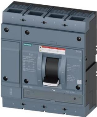
interruttore automatico 3VA5 UL Frame 800 classe del potere di interruzione M 35 kA con 480 V a 4 poli, protezione impianto TM230, FTAM, In=600 A, protezione da sovraccarico Ir=600 A con regolazione fissa protezione da cortocircuito li=5 ... 10 x In protezione del conduttore di neutro 1 attacco piatto a vite
