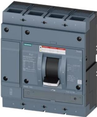
interruttore automatico 3VA5 UL Frame 800 classe del potere di interruzione M 35 kA con 480 V a 4 poli, protezione impianto TM230, FTAM, In=600 A, protezione da sovraccarico Ir=600 A con regolazione fissa protezione da cortocircuito li=5 ... 10 x In conduttore di neutro non protetto attacchi piatti a vite
