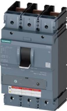
interruttore automatico 3VA5 UL Frame 600 classe del potere di interruzione C 100 kA @ 480 V a 3 poli, protezione impianto TM230, FTAM, In=600 A protezione da sovraccarico Ir=600 A con regolazione fissa protezione da cortocircuito I<sub>c</sub>=4 ... 8 x In UL489 SB (navale), 50 gradi Cel. senza collegamento
