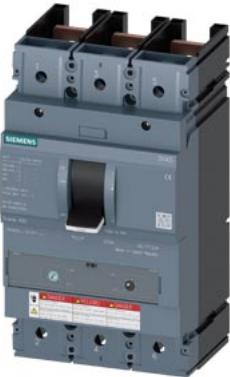
interruttore automatico 3VA5 UL Frame 600 classe del potere di interruzione C 100 kA @ 480 V a 3 poli, protezione impianto TM230, FTAM, In=600 A protezione da sovraccarico Ir=600 A con regolazione fissa protezione da cortocircuito I<sub>c</sub>=4 ... 8 x I<sub>n</sub> senza collegamento
