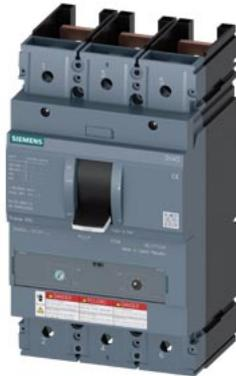
interruttore automatico 3VA5 UL frame 600 classe del potere di interruzione M 35 kA @ 480 V a 3 poli, protezione impianto TM230, FTAM, In=600 A protezione da sovraccarico Ir=600 A con regolazione fissa protezione da cortocircuito Ii=4 ... 8 x In UL489 SB (navale), 50 gradi Cel. senza collegamento
