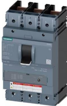
interruttore automatico 3VA5 UL frame 600 a 3 poli, protezione avviatore TM120M, AM, In=600 A senza protezione da sovraccarico protezione da cortocircuito li=3...6 x In senza collegamento
