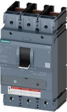
interruttore automatico 3VA5 UL Frame 600 classe del potere di interruzione C 100 kA con 480 V a 3 poli, protezione impianto TM230, FTAM, In=450 A protezione da sovraccarico Ir=450 A con regolazione fissa protezione da cortocircuito li=5 ... 10 x In UL489 SB (Naval), 50 gradi Cel. senza collegamento
