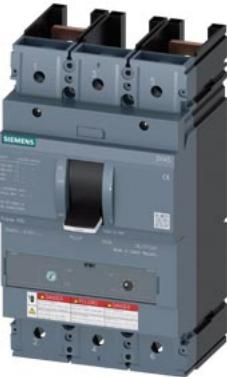
interruttore automatico 3VA5 UL Frame 600 classe del potere di interruzione H 65 kA con 480 V a 2 poli, protezione impianto TM230, FTAM, In=450 A protezione da sovraccarico Ir=450 A con regolazione fissa protezione da cortocircuito Ii=5 ... 10 x In senza collegamento
