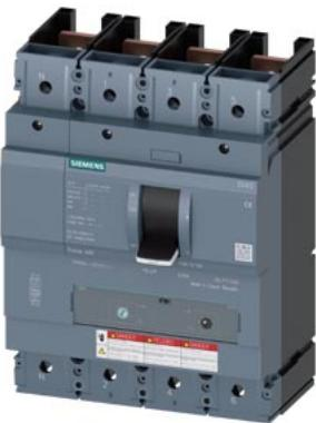
interruttore automatico 3VA5 UL Frame 600 classe del potere di interruzione M 35 kA con 480 V a 4 poli, protezione impianto TM230, FTAM, In=450 A protezione da sovraccarico Ir=450 A con regolazione fissa protezione da cortocircuito Ii=5 ... 10 x In protezione del conduttore di neutro 100 % senza collegamento
