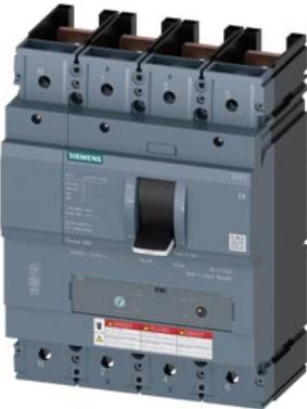
interruttore automatico 3VA5 UL Frame 400 classe del potere di interruzione C 100 kA con 480 V a 4 poli, protezione impianto TM240, ATAM, In=400 A protezione da sovraccarico Ir=320 A ... 400 A protezione da cortocircuito Ii=5 ... 10 x In conduttore di neutro non protetto senza collegamento
