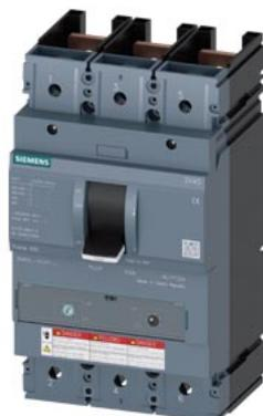
interruttore automatico 3VA5 UL Frame 400 classe del potere di interruzione H 65 kA con 480 V a 3 poli, protezione impianto TM240, ATAM, In=400 A protezione da sovraccarico Ir=320 A ... 400 A protezione da cortocircuito Ii=5 ... 10 x In senza collegamento
