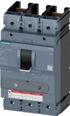
interruttore automatico 3VA5 UL Frame 400 classe del potere di interruzione H 65 kA con 480 V a 2 poli, protezione impianto TM230, FTAM, In=400 A protezione da sovraccarico Ir=400 A con regolazione fissa protezione da cortocircuito I<sub>c</sub>=5 ... 10 x I<sub>n</sub> senza collegamento
