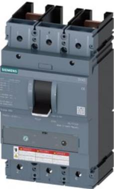
interruttore automatico 3VA5 UL Frame 400 classe del potere di interruzione M 35 kA con 480 V a 2 poli, protezione impianto TM230, FTAM, In=400 A protezione da sovraccarico Ir=400 A con regolazione fissa protezione da cortocircuito Ii=5 ... 10 x In senza collegamento
